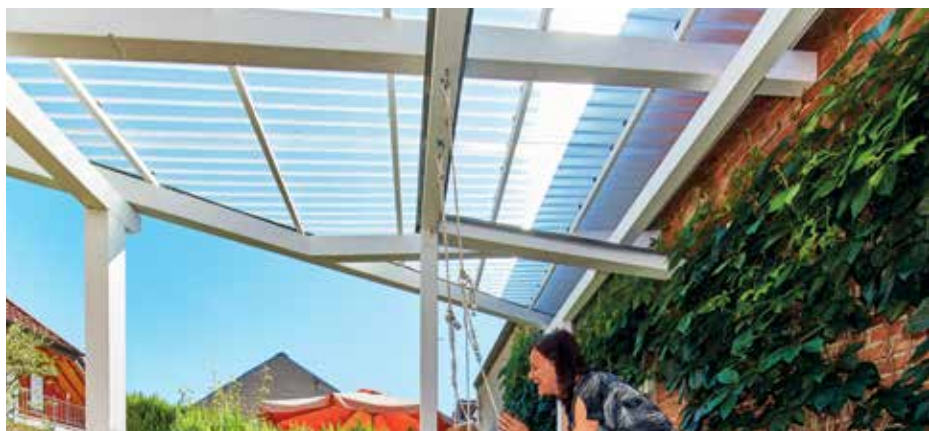
Schützende Bedachung mit Polycarbonat Sinus-Profil 76/18 klar
